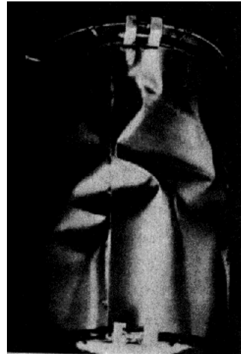
Figura.4 Aspecto externo de la pérdida de estabilidad del equilibrio en un cilindro de paredes delgadas con presión exterior.
