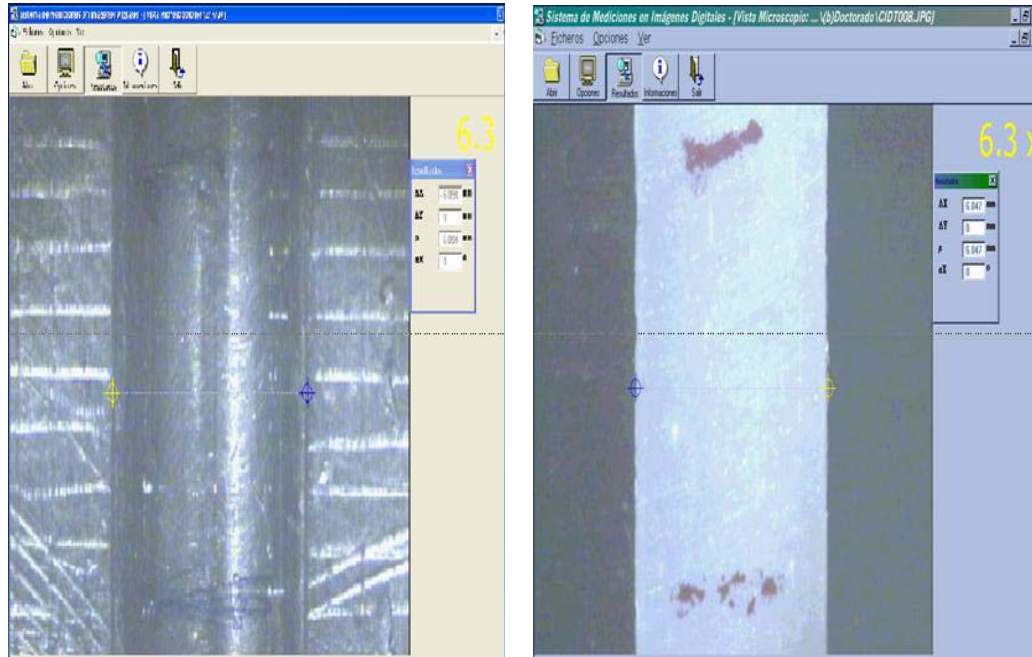
Figura 3 - Foto para la medición de la cavidad (a la izquierda) y de la pieza (a la derecha.)
