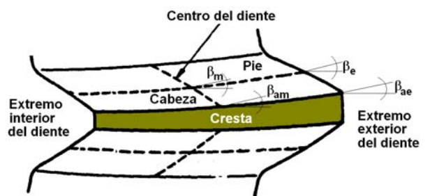
Figura 7 - Diferentes ángulos de inclinación de la hélice del diente según el diámetro y la distancia de medición en el diámetro exterior ( \beta_{ae} , \beta_{am} , \beta_e y \beta_m ).
