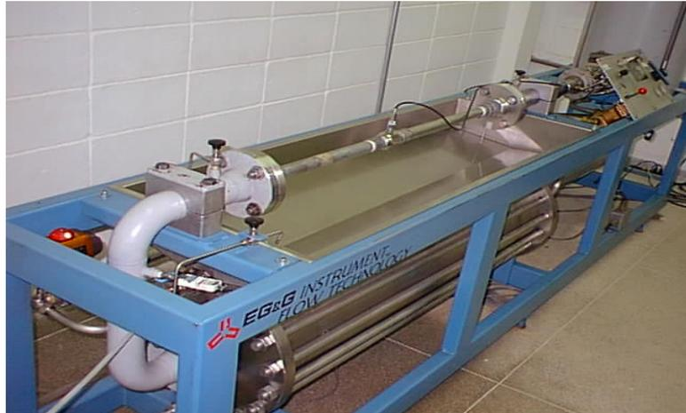
Figura 5. Piston Prover empleado en la cuantificación de la variación del factor  $K$  de los medidores ensayados.
