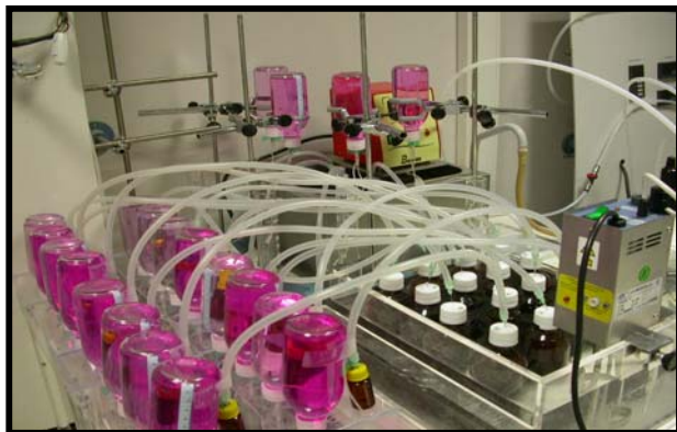
Figura 1. Aspecto de los reactores en el SET a 35°C y en el Test de Actividad Metanogénica.
