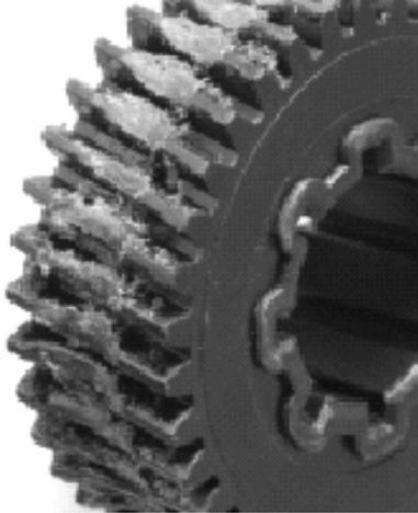
Figura 3 - Deformación del diente debido al excesivo calor.
