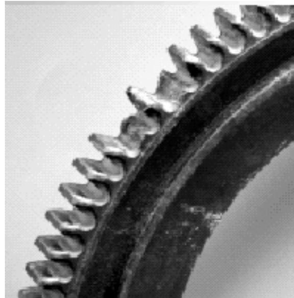
Figura 2 - Fractura del diente debido a la sobrecarga.
