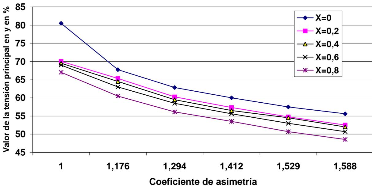
Figura 6 -: Variación de las tensiones principales ( $\sigma_y$ ) en función del coeficiente de asimetría y de la corrección para un ángulo del perfil del diente en la zona de ataque de 17°.
