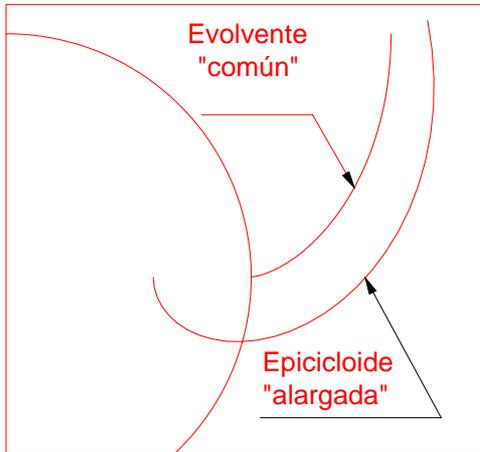
Figura 6 - Comparación entre la epicicloide “alargada” y la evolvente “común”.
