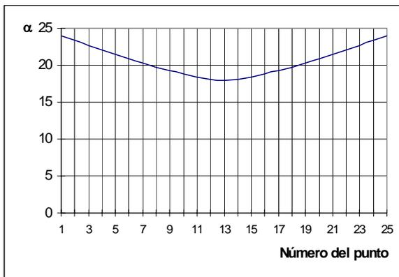
Figura 8 - Ángulo de presión ( $\alpha$ ) vs punto de la línea de engranaje en el perfil epicicloidal alargado.
