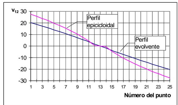
Figura 10 - Velocidad de deslizamiento relativo ( $v_{12}$ ) vs punto de la línea de engranaje.
