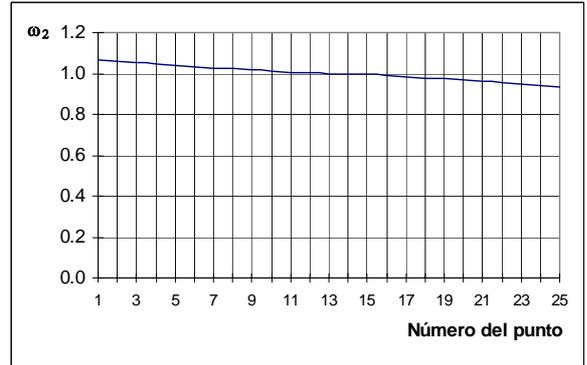
Figura 9 - Velocidad angular ( $\omega_2$ ) vs punto de la línea de engranaje en el perfil epicicloidal alargado.
