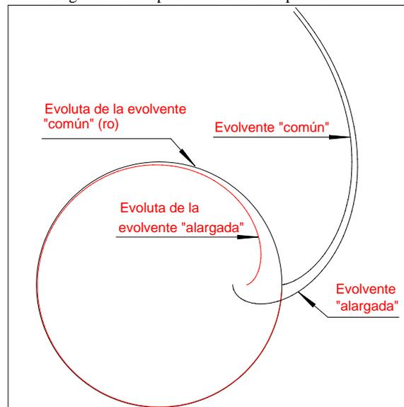
Figura 4 - Comparación entre las evolventes.
