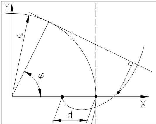
Figura 2 - Curva evolvente de círculo.
