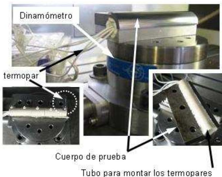
Figura 2. Modelo del cuerpo de prueba utilizado en los ensayos.
