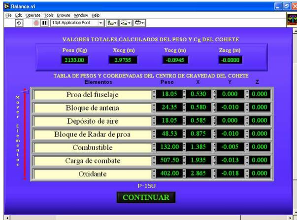
Figura. 9 Instrumento virtual del sistema de medición del peso y coordenadas del centro de gravedad de la aeronave.
