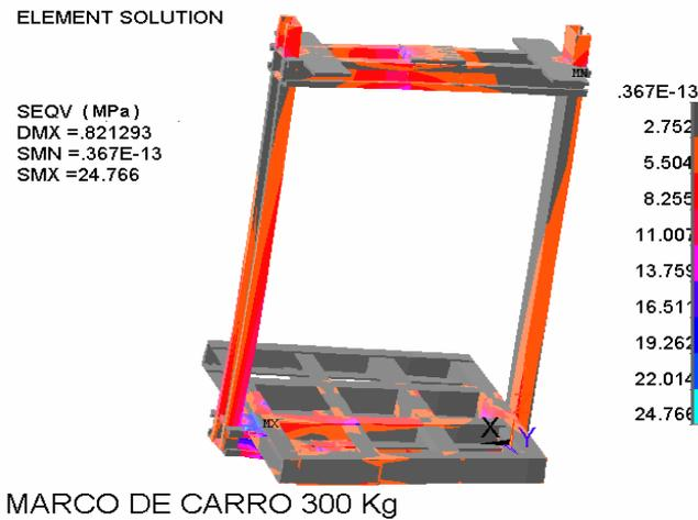
Figura 9. Tensión equivalente de la estructura con modificación de espesor de placa soporte.
