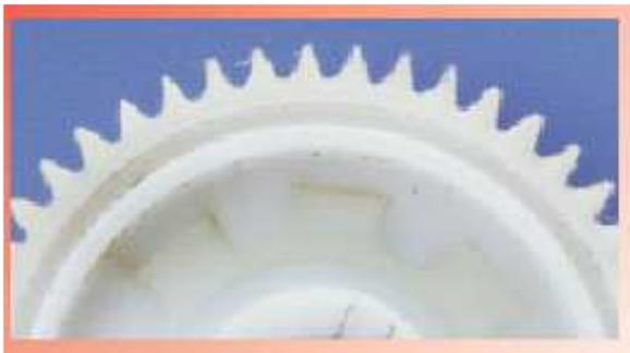
Figura 1: Afinamiento del diente producto del desgaste.
