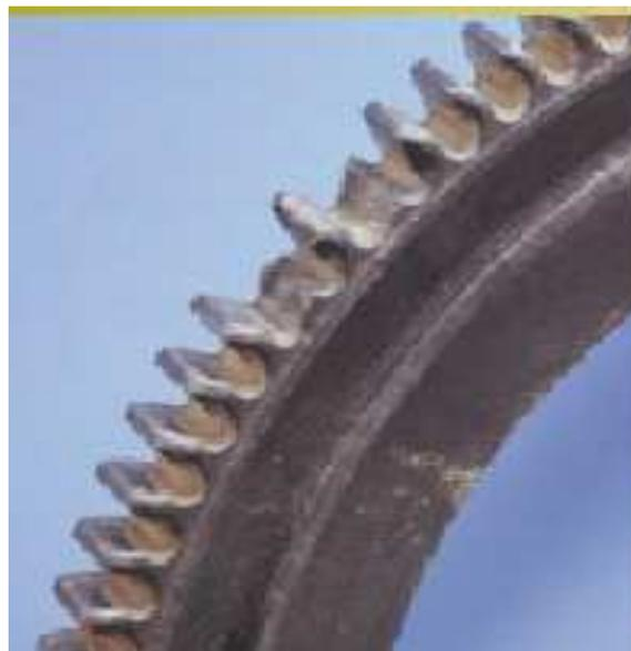
Figura 2 : Fractura del diente debido a la sobrecarga.
