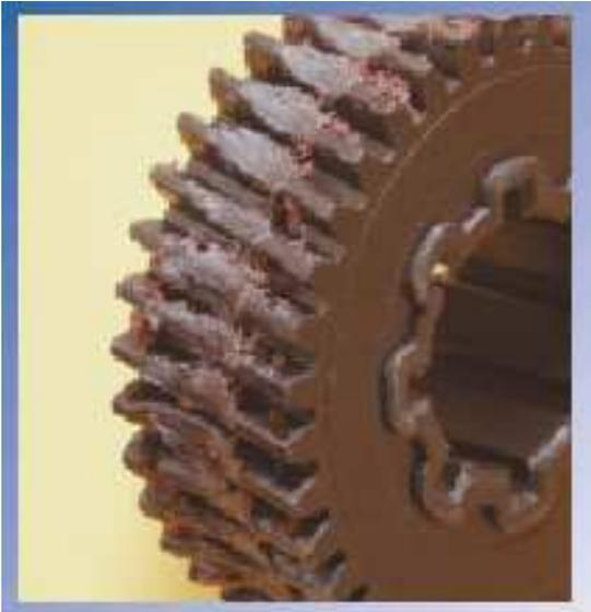
Figura 3: Deformación del diente debido al excesivo calor.
