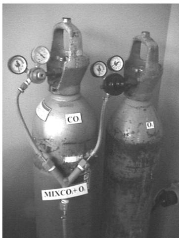
Figura 3. Mezclador de gases.
