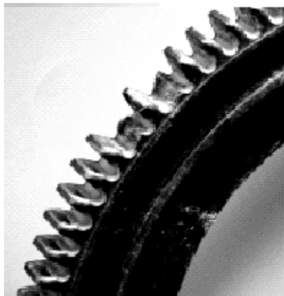
Figura 2 : Fractura del diente debido a la sobrecarga.
