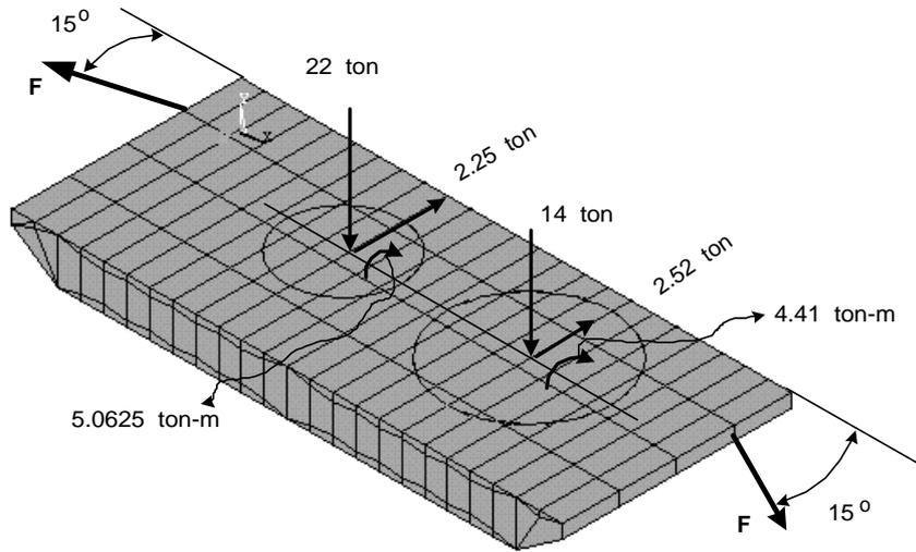
Figura 7.-Cargas sobre la patana.( En la figura no esta representada la presión del agua ).
