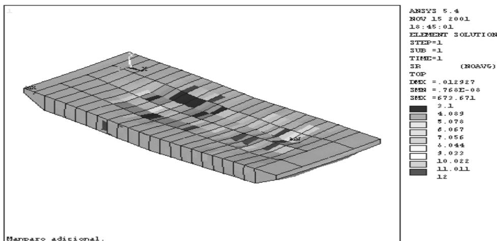
Figura 10 .-Coeficientes de Seguridad SR, mínimos.
