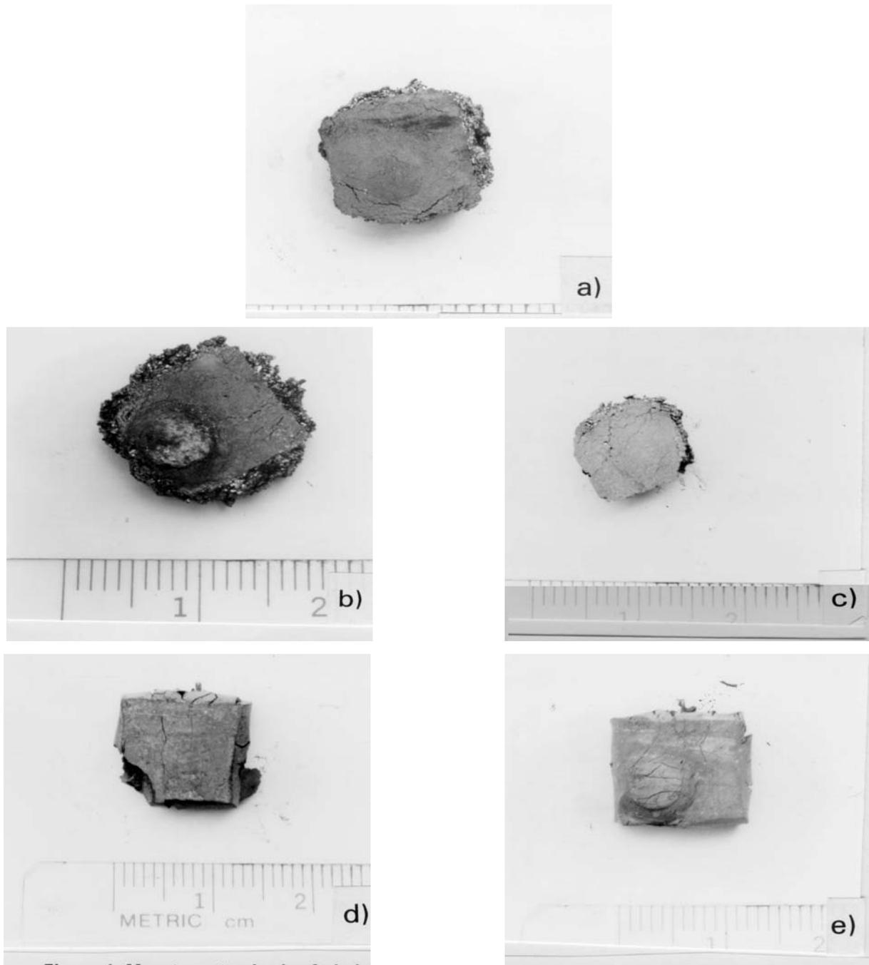
**Figura 4.** Muestras atomizadas forjadas. a) FeAl; b) FeAl40 + B; c) FeAl40 +B + HIP; d) FeAl40 + B + Al<sub>2</sub>O<sub>3</sub> y e) FeAl40 + B + Al<sub>2</sub>O<sub>3</sub> + HIP.
