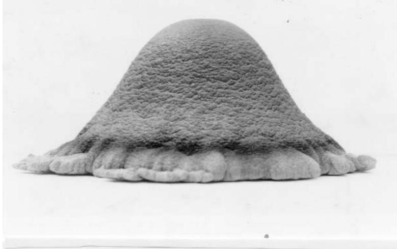
**Figura 2:** FeAl40 refundido y solidificado por atomización.
