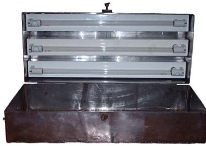
Fig. 2. Reactor UV de canal abierto
