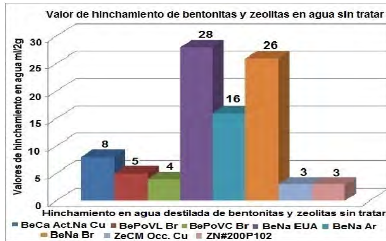
Fig. 10. Valores de hinchamiento en agua destilada en bentonitas y zeolitas no tratadas
