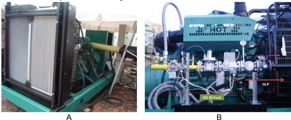
**Fig. 2.** Motogenerador Cummins DFEH (a) e instalación del Kit Bifuel antes del ingreso de aire al turbocargador (b)
