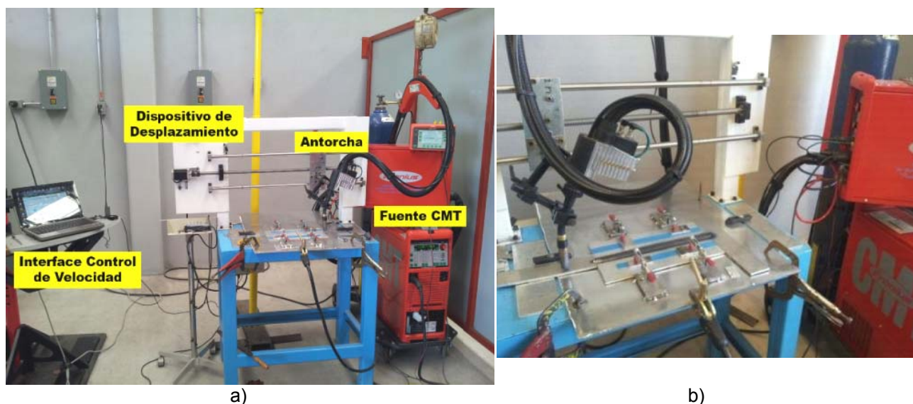
Fig. 1. Instalación para posicionar y sostener los cupones, así como para el desplazamiento regulado de la antorcha CMT
