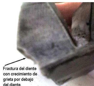
Figura 5. Clásica fractura de rueda cónica por insuficiente espesor de llanta para soportar las cargas de trabajo. Notar que la grieta no crece a lo largo de la base del diente.
