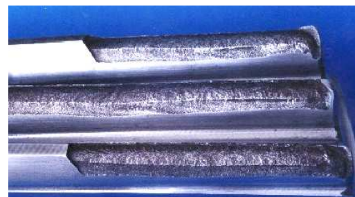
Figura 3. Dientes fracturados por grieta generada a lo largo del límite de la zona efectiva de cementado y provocada por escasa resistencia a la fatiga del material ante la carga aplicada [1].
