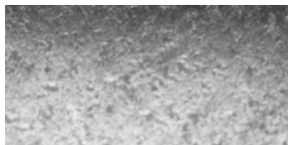
Figura 2. Corte transversal en la superficie del pasador tratado térmicamente. 100X.
