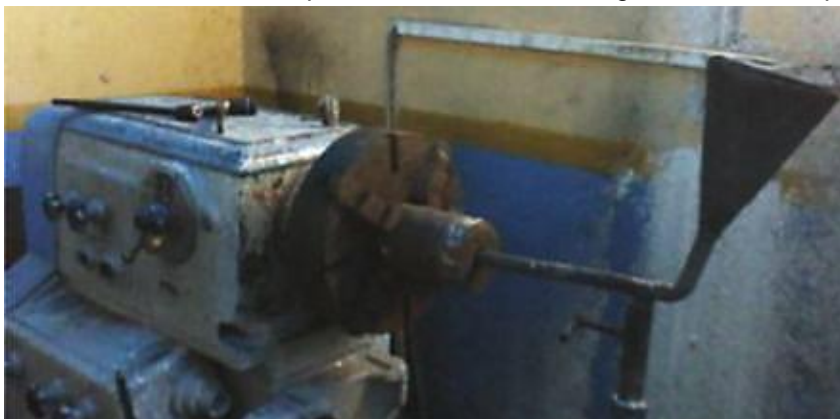
Fig. 1. Dispositivo diseñado para preparar las probetas por fundición centrífuga. Fuente: Autores
