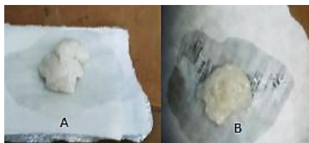
Fig.4. Muestras de colágeno obtenido, a) colágeno obtenido de la piel de cerdo, b) colágeno obtenido de las patas del pollo. Fuente: elaboración propia
