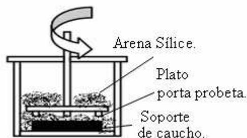
**Figura 1.** Máquina de desgaste abrasivo.
