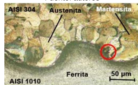
Fig. 5d. Zona a 25 mm de la explosión. Fuente: autores
