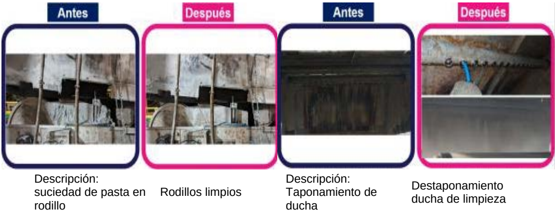
Fig. 2. Ejemplo de solución de fuentes de contaminación. Fuente: elaboración propia
