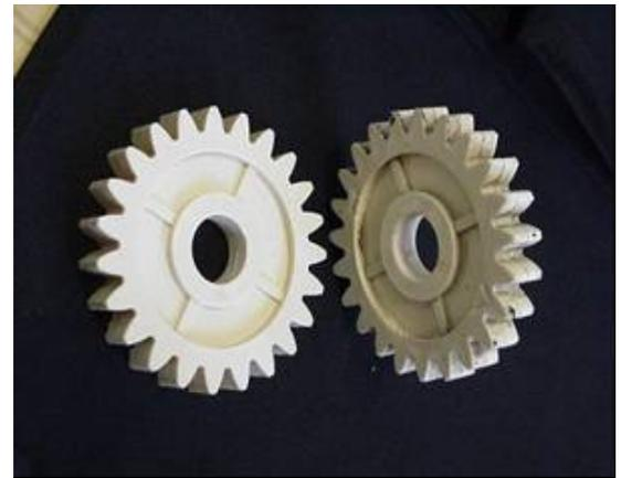
Figura. 8 Rueda dentada plástica asimétrica de perfil recto moldeada.
