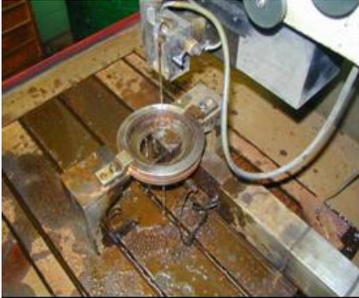
Figura 5 Proceso de electroerosión de un molde.
