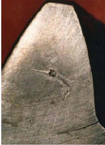
Figura 3. Muestra de fractura del diente en la base por fatiga volumétrica del material [3].
